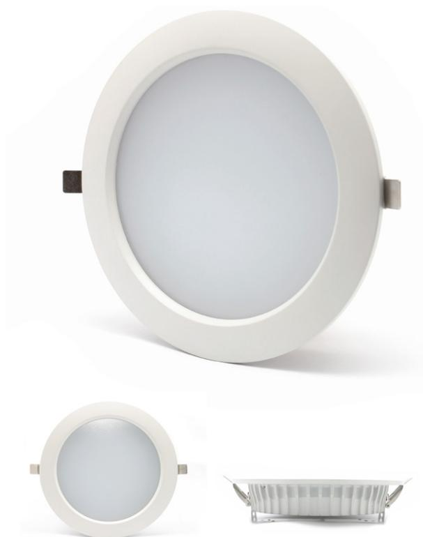
Plafonnier d'intérieur circulaire encastrable 25 W à technologie LED. Haute luminosité dans un encombrement réduit (2200 lm pour un diamètre de 23 cm). Corps blanc en aluminium + acier avec languettes de maintien montées sur ressorts. Partie lumineuse centrale en PMMA diffusant.
