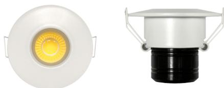
Spot d'intérieur encastrable à LED 3W à encombrement réduit (seulement 35mm de hauteur pour 50mm de diamètre). Technologie Chip-on-board pour un maximum de luminosité. Angle de 60°. Corps en aluminium blanc. Fixation facile par languettes de maintien montées sur ressorts. Livré avec un contrôleur d'alimentation.
